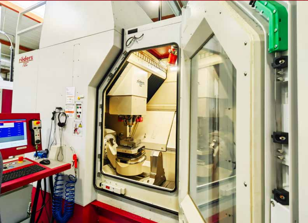
5轴硬加工，精度达微米级：Gerhard Rauch目前使用五台来自RXP系列的自动化罗德斯（Röders）铣削加工中心（照片：Klaus Vollrath）
